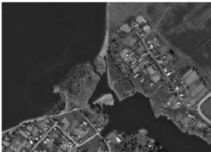
Рис. 2. Причленившийся к берегу торфяной плавучий остров, остановил потоки вдольбереговых наносов и стимулировал развитие широкого пляжа и береговой террасы
