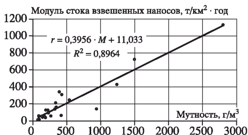
Рис. 4. Связь между мутностью речных вод и модулем стока взвешенных наносов (по данным табл. 5) Уравнение регрессии: r – модуль стока взвешенных наносов ( \text{т/км}^2 \times \text{год} ), M – мутность речных вод ( \text{г/м}^3 ), R^2 – коэффициент достоверности аппроксимации
