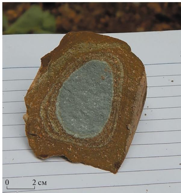
Рис. 6. Характер выветривания галечного материала в водотоках на склонах вулкана Менделеева (руч. Валентины, о-в Кунашир, 2019 г.).
