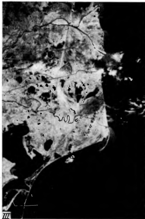
Рис. 1. Снимки дельты Дуная со спутника «Ландсат-1», полученные 4 сентября 1972 г. в диапазонах: I — 0,5—0,6; II — 0,6—0,7; III — 0,7—0,8; IV — 0,8—1,1 мкм
