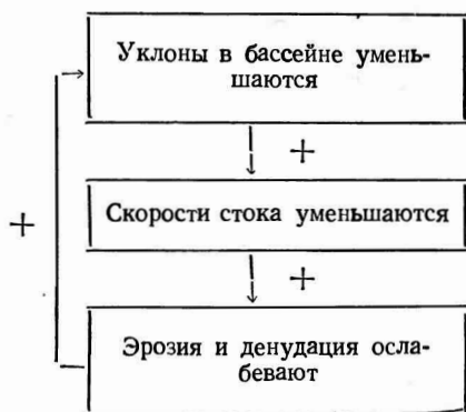
Рис. 5. Схема обратной связи в системе «речной бассейн — сток»
