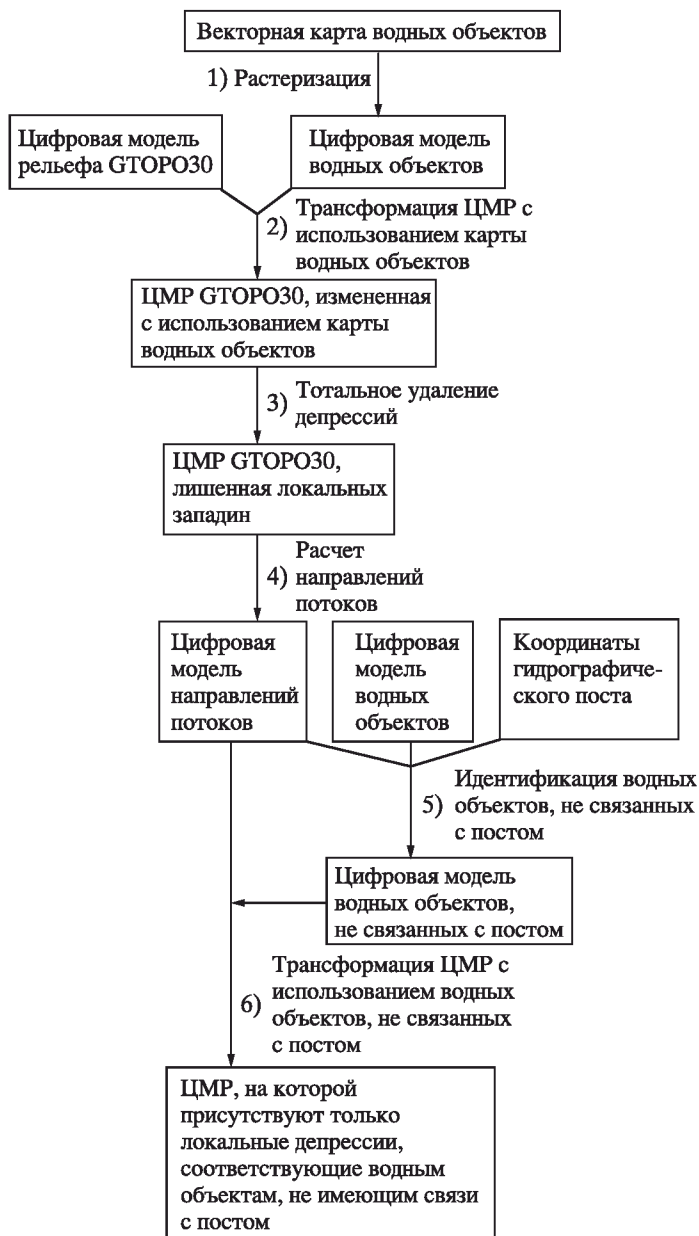
Рис. 2. Принципиальная схема предлагаемой методики автоматизированной подготовки ЦМР
