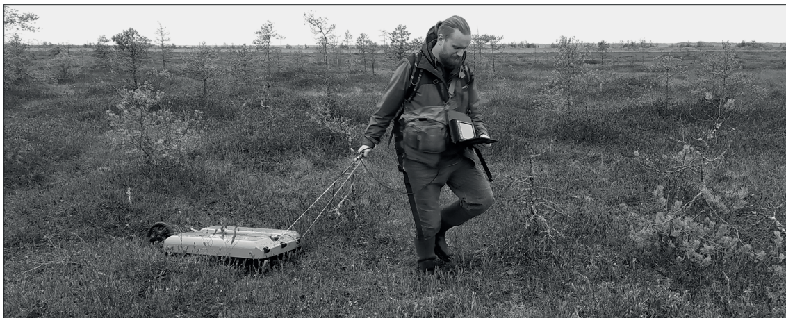
Рис. 2. Фотография процесса выполнения георадарной съемки.
