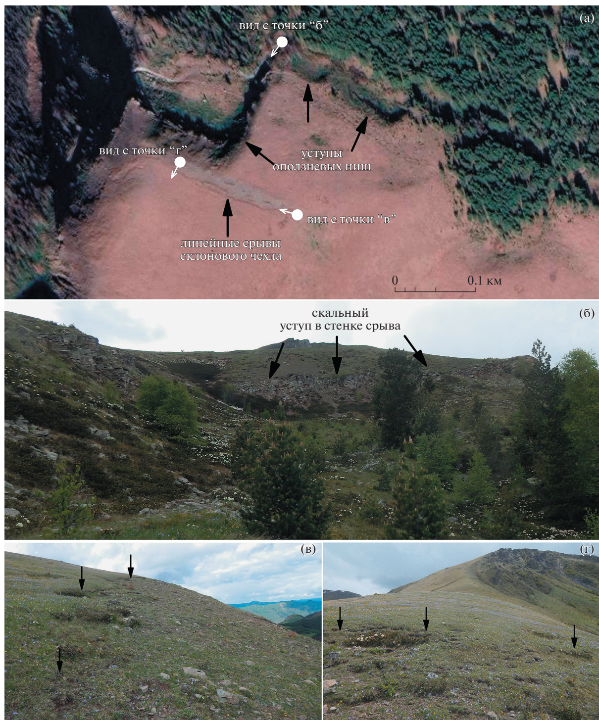
Рис. 6. Блоковые оползни и линейные срывы склонового чехла. (а) — космический снимок; (б) — вид на оползневую нишу; (в) — вид вдоль срыва склонового чехла; (г) — вид вкрест фронтальной части срыва склонового чехла, на заднем плане — стенка срыва оползня в верховьях долины р. Кильяну.
