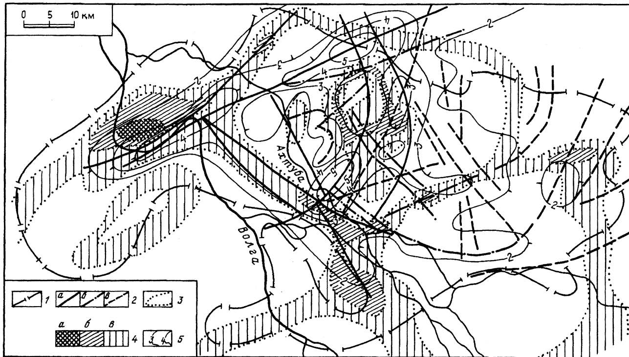
Рис. 2. Карта масштаба 1:500000 экологического состояния района Астраханского газоконденсатного месторождения, связанного с дегазацией пород в зонах новейшей тектонической активизации трещиноватости и разрывных нарушений 1 – контур Астраханского газоконденсатного месторождения, 2 – проявленные в современном рельефе и на космо- и аэроснимках разрывные нарушения и зоны трещиноватости разной интенсивности тектонической активизации в четвертичное время: а – наиболее активные, б – средней активности, в – слабой активности, 3 – граница участков разуплотненных пород геологического разреза, 4 – степень дегазации пород геологического разреза по данным газовой съемки 1977–80 гг., проинтерпретированной А.А. Акимовой и др. [6]: а – весьма активная дегазация, б – дегазация средней активности, в – слабая дегазация, 5 – баллы экологической напряженности
