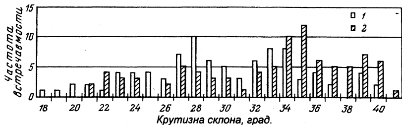
Рис. 2. Частотное распределение крутизны элементарных склонов низкогорного и среднегорного рельефа с абсолютной высотой 600–1300 м (область распространения курумов) 1 – южные экспозиции, 2 – северные экспозиции
