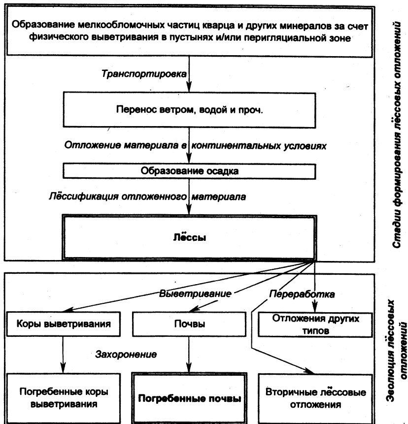
Рис. 2. Схема формирования и дальнейшей эволюции лёссовых отложений (по Хеллеру и Эвансу [4])
