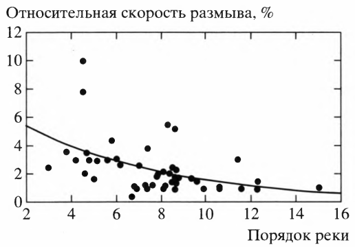
Рис. 3. Зависимость относительной скорости размыва берегов от порядка реки
