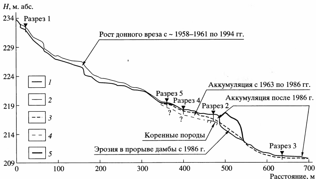
Рис. 3. Продольный профиль детально обследованной части оврага и реконструированные объемы эрозии и аккумуляции в разные этапы развития 1 – современный тальвег; 2 – дноще оврага; реконструированная поверхность: 3 – 1986 г., 4 – 1963 г.; 5 – дамба
