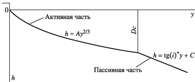
Рис. 4. Схема подводного берегового склона водохранилища
