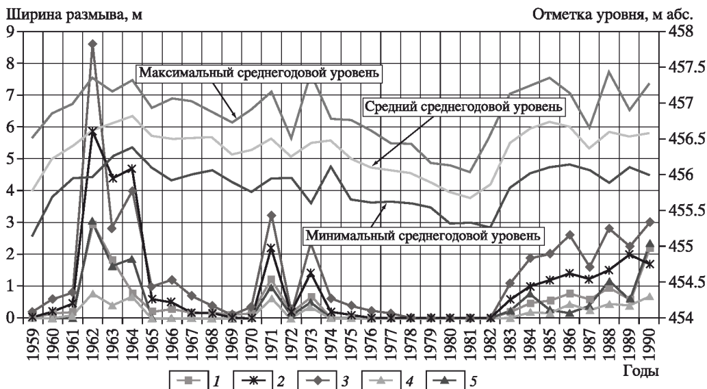
Рис. 1. Размыв берегов различного геологического строения при колебаниях уровня воды оз. Байкал в 1959–1990 гг. (данные представлены Ю.Б. Тржцинским и Г.И. Овчинниковым) 1 – глина и суглинки, 2 – суглинок, глина и песок, 3 – песок, 4 – валуны и галька, 5 – песок и галька
