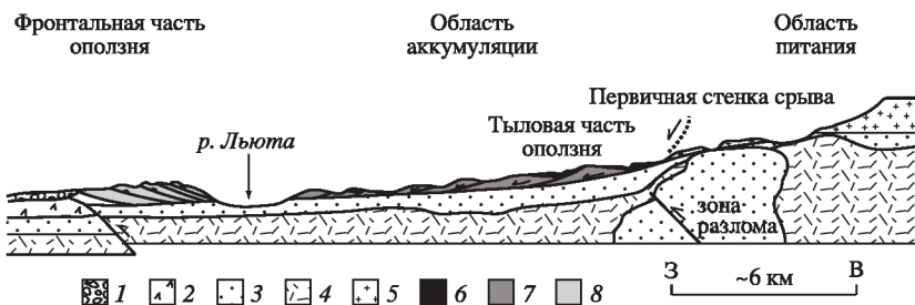
Рис. 4. Обвал Льюта в северном Чили (18°23' ю.ш., 69°45' з.д., 3000 м над у.м.). Разрез показывает современное стратиграфическое и геоморфологическое положение обвала Льюта. Профиль проведен параллельно линии движения оползня [40]
