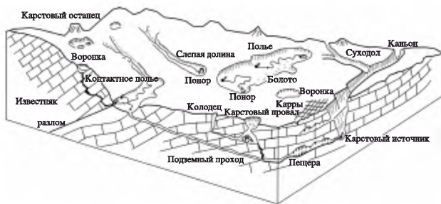
Рис. 2. Строение карстовой системы (составлено автором с использованием [21])
