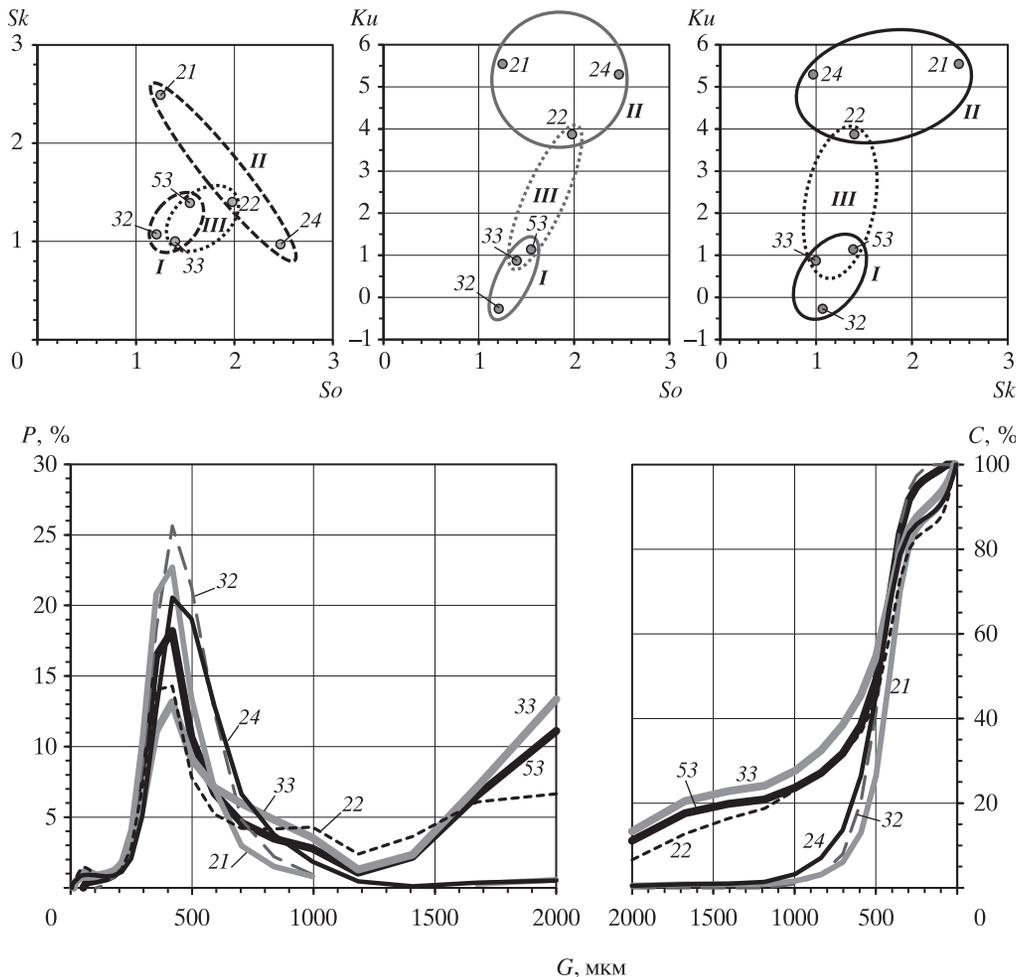
Рис. 11. Соотношения гранулометрических характеристик, кривых частотного ( $P, \%$ ) и кумулятивного ( $C, \%$ ) распределений ГМС для всех образцов песков с  $Mo = 419$  мкм комплекса Сарыкум и его окрестностей;  $G$  – размерность ГМС
