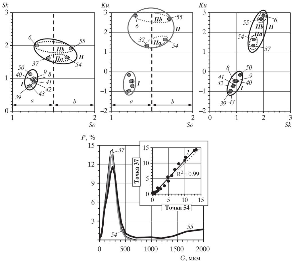
Рис. 12. Соотношения гранулометрических характеристик для всех образцов песков с  $M_o = 249$  мкм (вверху), кривых распределения частот ГМС (внизу) и их взаимной корреляции для образцов тт. 37 и 54 комплекса Сарыкум и его окрестностей. Усл. обозначения см. рис. 7–8
