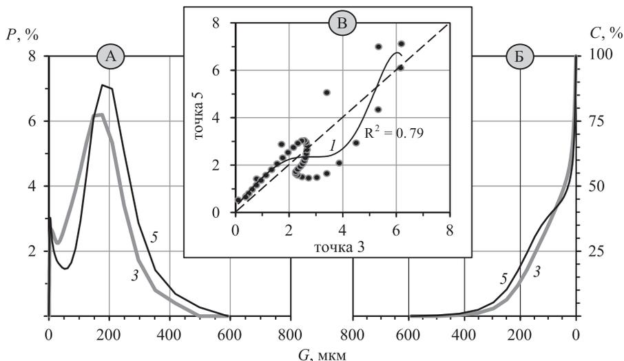
Рис. 15. А – частотные и Б – кумулятивные кривые распределения ГМС, В – диаграмма корреляции частот распределения ( $P$ , %) песков окрестностей комплекса Сарыкум в тт. 3 и 5 с  $M_o = 176$  мкм
