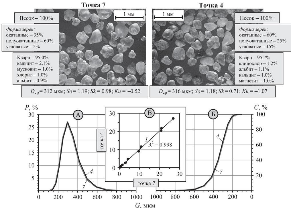
Рис. 14. Соотношения характеристик гранулометрического и минерального составов образцов песков т. 4 и 7 с  $M_o = 296 \text{ мкм}$  комплекса Сарыкум
