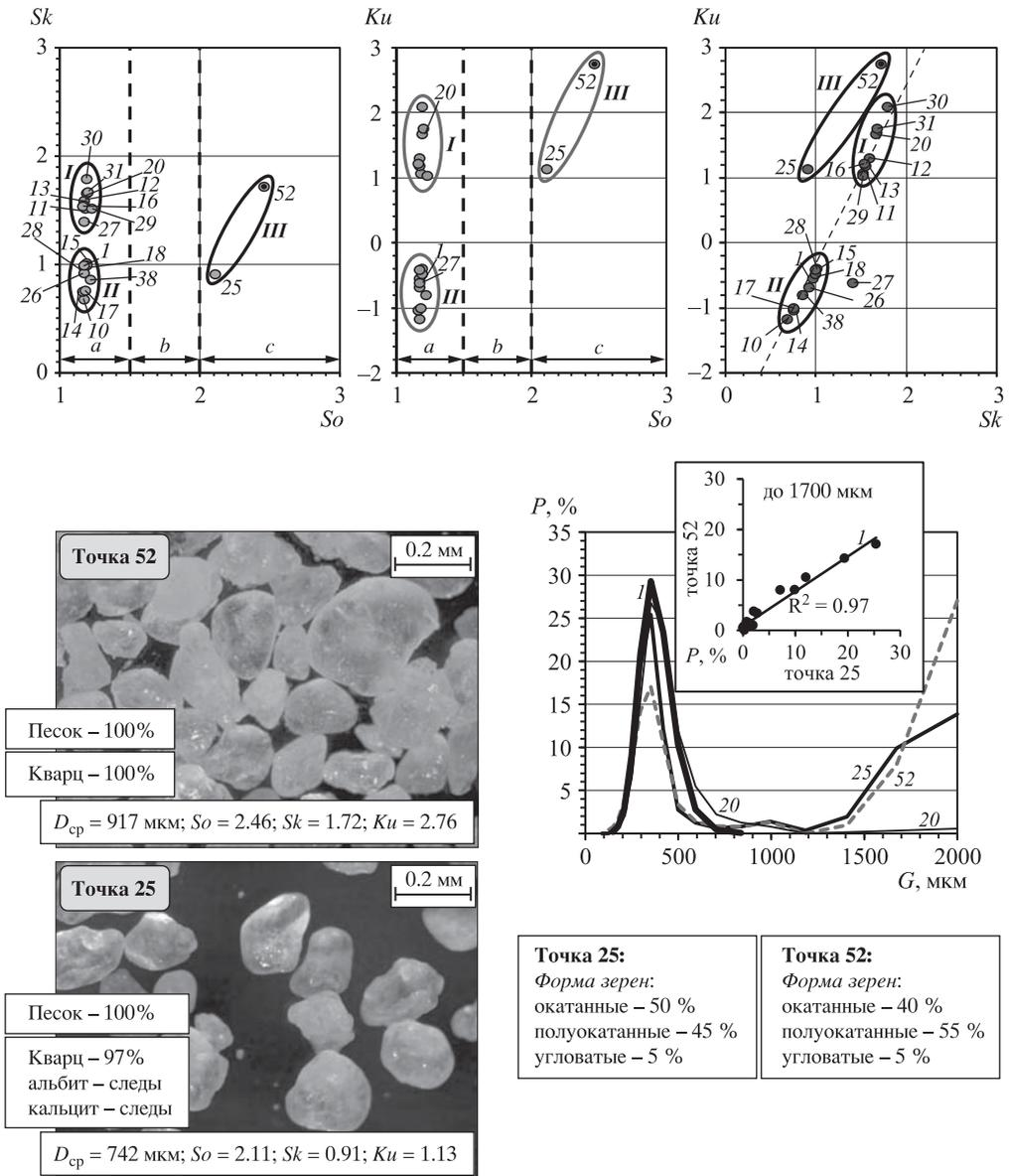
Рис. 8. Соотношения гранулометрических характеристик по всем образцам с  $Mo = 352$  мкм (вверху) и сопоставление этих характеристик и минерального состава, кривых распределения частот ГМС ( $P$ , %) и коэффициентов их взаимной корреляции по образцам тт. 25 и 52 комплекса Сарыкум и его окрестностей (внизу)  $l$  – линейный тренд,  $R^2$  – коэффициент аппроксимации линейного тренда,  $G$  – размерность ГМС. Остальные усл. обозначения см. рис. 7
